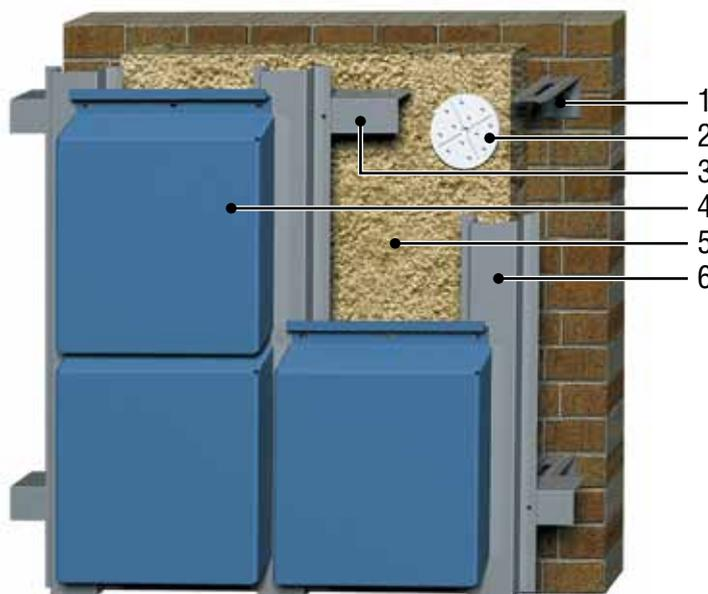
Система применяется для облицовки общественных, промышленных и жилых зданий высотой до 75 метров. Конструкция предназначена для облицовки стен зданий из следующих материалов: красного, силикатного и пустотелого кирпича, пенобетона, газобетона, монолитного железобетона, железобетонных панелей с объемным весом не менее 600 кгс/м<sup>3</sup>.
