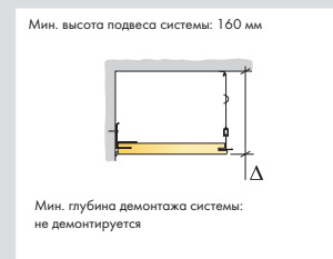
Параметры подвеса системы с кронштейном frieze bracket
