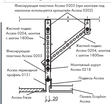
Примыкание потолка к стене 1 (узел: A2_C23)
