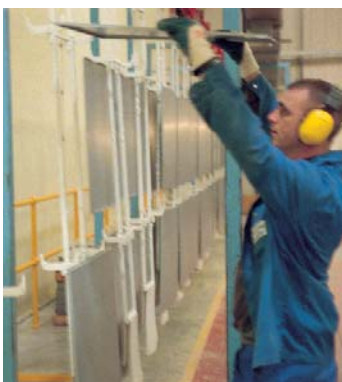
▲ Формованные панели на покрасочном конвейере перед покраской
