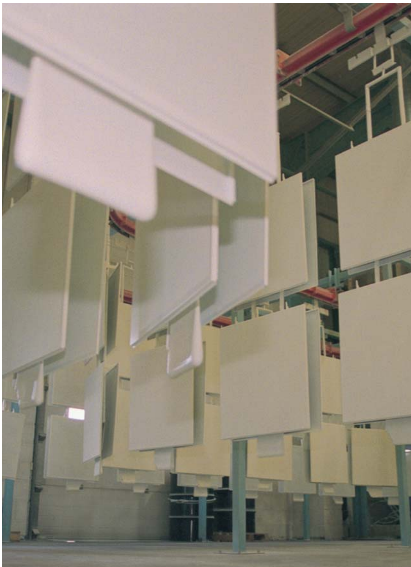
▲ Формованные панели после порошковой покраски электростатическим способом
