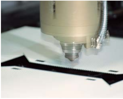
▲ Прецизионная лазерная резка отверстия под светильник
