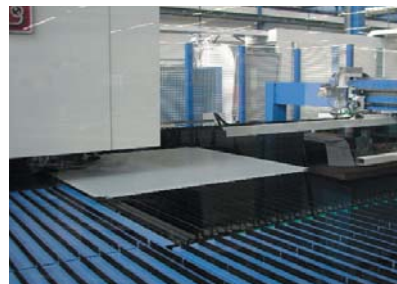
▼ Прецизионное автоматизированное сгибание панелей
