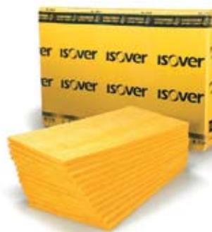
ISOVER ПлавающийПол предназначен для использования в качестве упругого основания плавающих полов. Благодаря высоким демпфирующим свойствам он обеспечивает максимальную защиту от ударного шума. Применение материала ISOVER ПлавающийПол в конструкциях плавающих полов со стандартной стяжкой весом 100 кг/м<sup>2</sup> позволяет понизить уровень ударного шума под перекрытием на 37 дБ (заключение по результатам акустических испытаний НИИСФ от 27.08.08).
