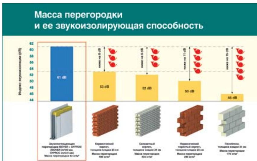
Соотношение массы ограждающей конструкции (перегородки) и ее звукоизолирующей способности
