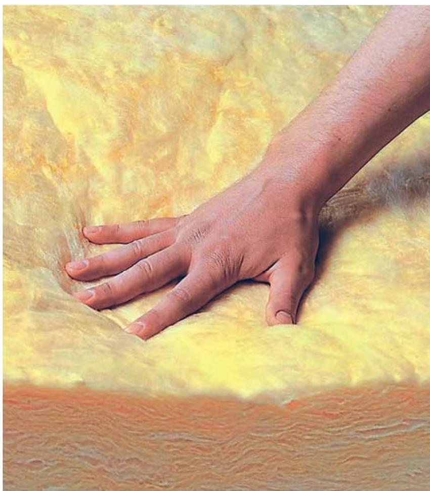
Минеральная вата на основе стекловолокна ISOVER однородная, не имеет неволокнистых включений – «корольков», благодаря чему материал обладает низкой теплопроводностью и высокой теплотехнической эффективностью.
