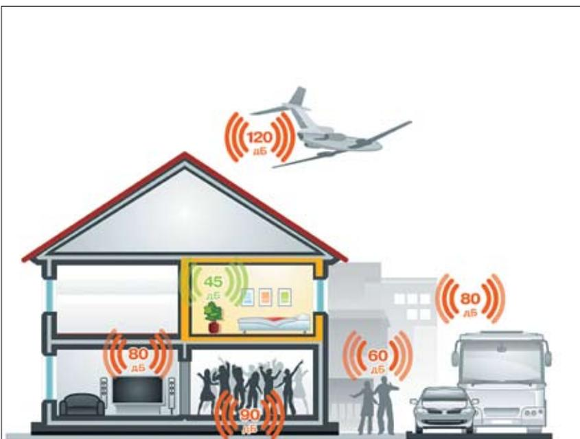
Важно защитить здание от шума — как с улицы (внешний шум), так и из соседнего помещения (внутренний шум). Легкие звукоизолирующие конструкции со звукопоглощающими материалами служат эффективным способом звукоизоляции.
