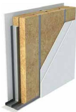
Рис. 18. Перегородка на каркасе Сургос–Ультра
