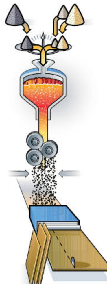
Технология REX Производство каменной ваты
