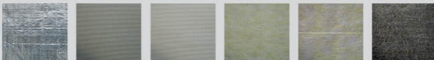
алюминиевая фольга стеклоткань 120 гр/м 2 стеклоткань 220, 420 гр/м 2 стеклохолст 40 гр/м 2 усиленный стеклохолст 40 гр/м 2 стеклохолст 60 гр/м 2
