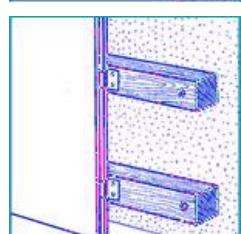
4. Заведите в паз установленной панели гребень следующей и соедините по всей длине. Продолжайте сборку панелей до завершения участка отделки
