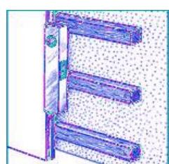
3. Вставьте крепежную скобу (кляймер) в паз панели и зафиксируйте ее с помощью гвоздей
