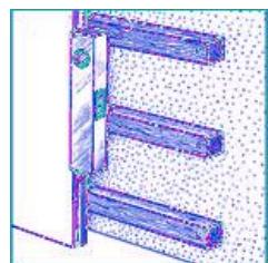
3. За выступающий лепесток закрепить панель на брусках с помощью строительных скрепок (гвозди не использовать, разрушается гребень)
